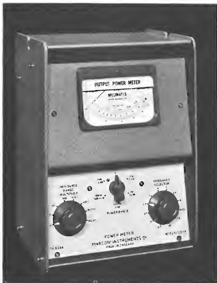
Fig. 2.4.4.1 Il misuratore di potenza di uscita Marconi Instruments Ltd. Mod. TF 893 A.
